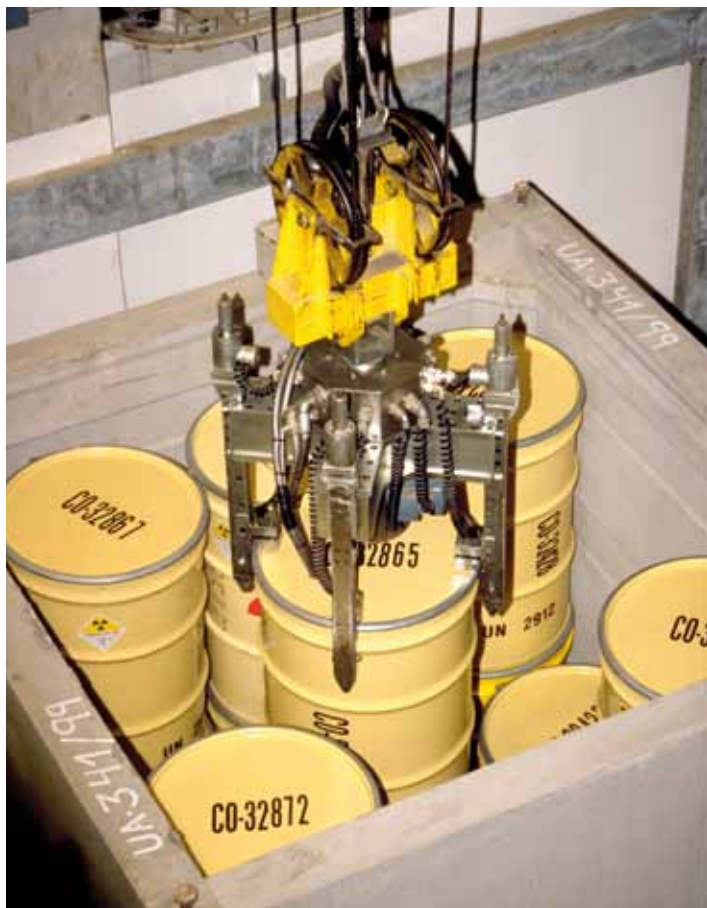
Manejo de bidones con residuos radiactivos de baja intensidad en el almacenamiento de El Cabril, Córdoba, propiedad de Enresa
